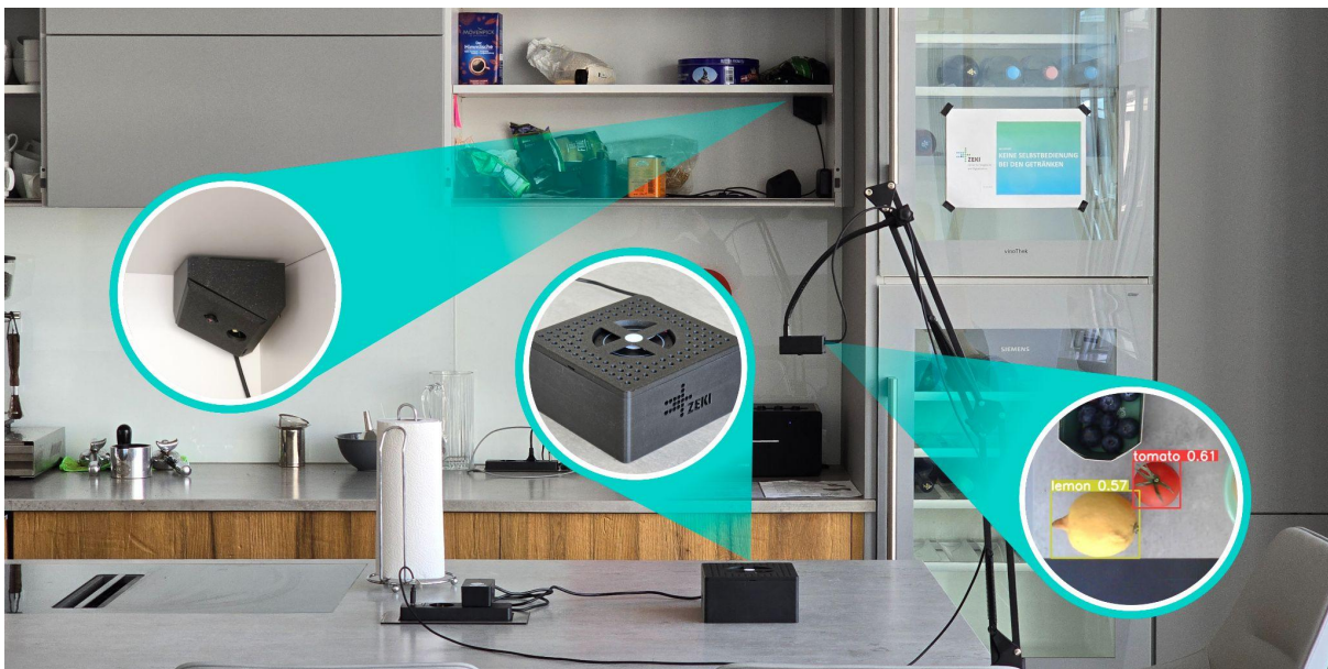
ABBILDUNG: Das Smart Kitchen-Setup zeigt die Platzierung der ESP-32-Kamera und die Artikelerkennung mit YOLOv8-Worldv2.
