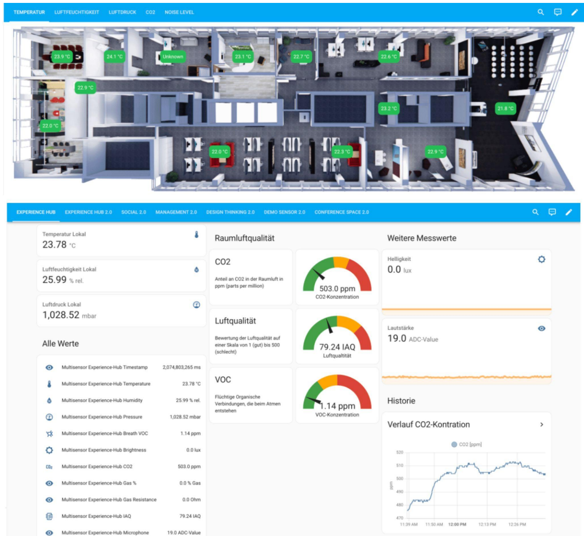
ABBILDUNG: Visualisierungs-Dashboard: Überlagerung von Umweltkennzahlen auf dem ZEKI-Grundriss mit Home Assistant.
